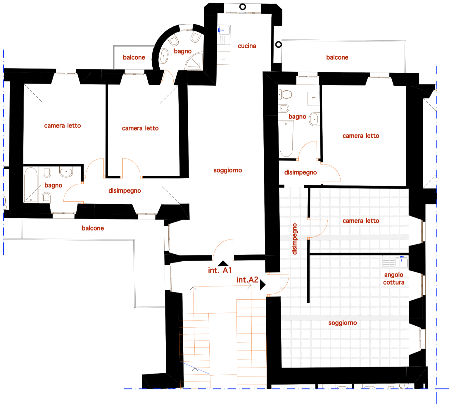
Alloggi A1 e A2 Piano Primo scala 1:100
